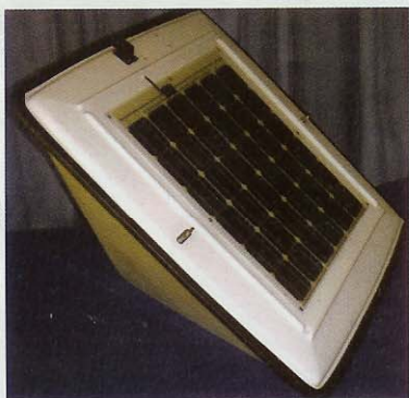
Die Solarboje liefert 50 Wp, je nach Bedarf mit 12 bis 48 Volt. In die Boje kann ein Regler integriert werden.
